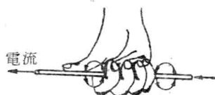
圖 1-7 以安培右手定則判定長直導線中電流與其周圍磁場之方向
