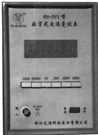
图 1-4 交流毫伏表面板示意图
