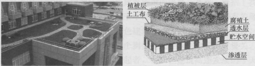
图 20 屋顶绿化和雨水收集利用
