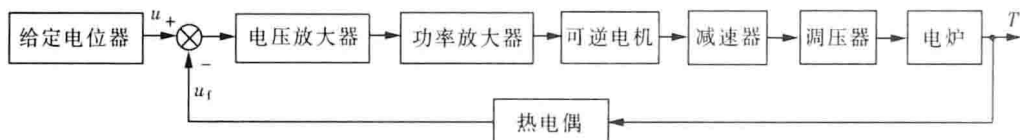
图 1-17 电炉温度控制系统的方框图
