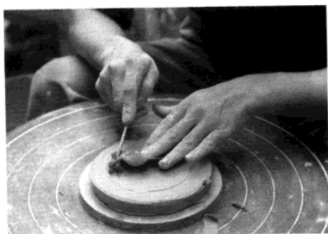
(2) 印好底后即挖足(高仿模拟)
