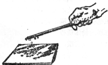
圖 313 用綢子摩擦玻璃棒能吸引輕小物體的示意圖
