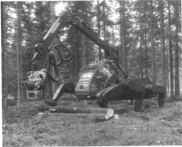
图 1.3 Plushtech 开发的第一个应用驱动的行走机器人。它专门移动砍伐森林的木材。其腿的协调是自动的,但导航依旧由机器人上的人类操作员进行( http://www.plustech.fi )。© Plustech
