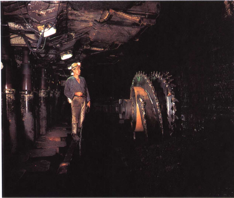
这是一个地下矿井。使用重型机械将矿石切割并破碎成可处理的碎块(图右),当工作面向前推进时,这些机械可支撑矿井的顶部(图左)。
