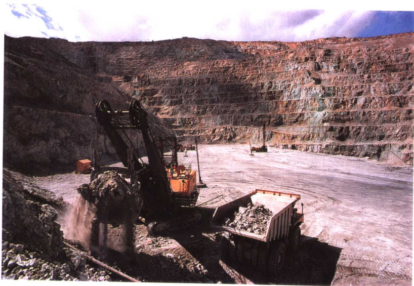
图为一个露天开采的铜矿。矿工们用动力铲土机把带岩石的矿石装上卡车，将在被称为梯段的水平层中的矿石移出。这些梯段形成了一条连续的路通向矿井各个侧面。载重卡车把矿石运上梯段并运出矿井。
