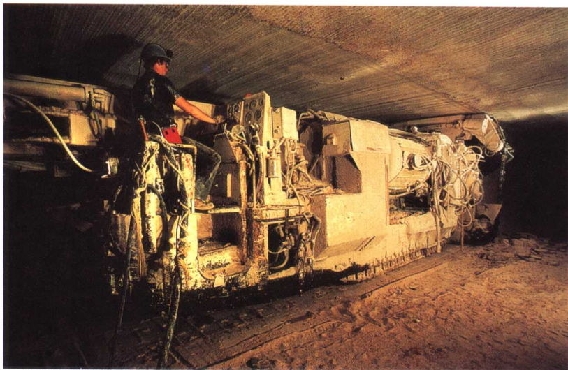
一位矿工在地下深处的水平矿层挖煤或矿石。该机在旋转切割开采矿石并把矿石装上区间运输的汽车。
