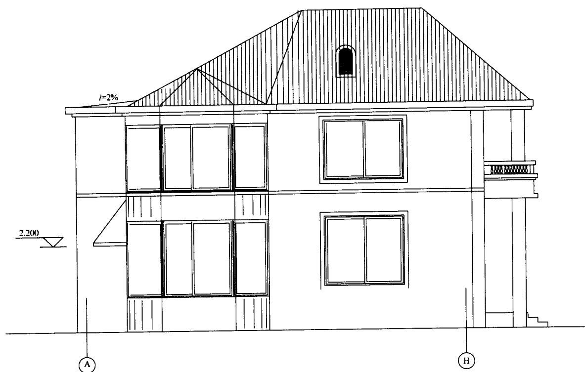
图 1-1-7 某二层住宅侧④~⑧轴立面图
