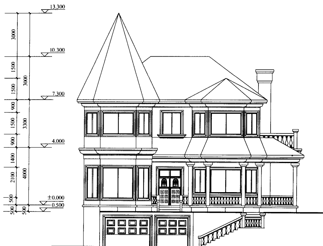
图1-1-3 某二层住宅正立面图
