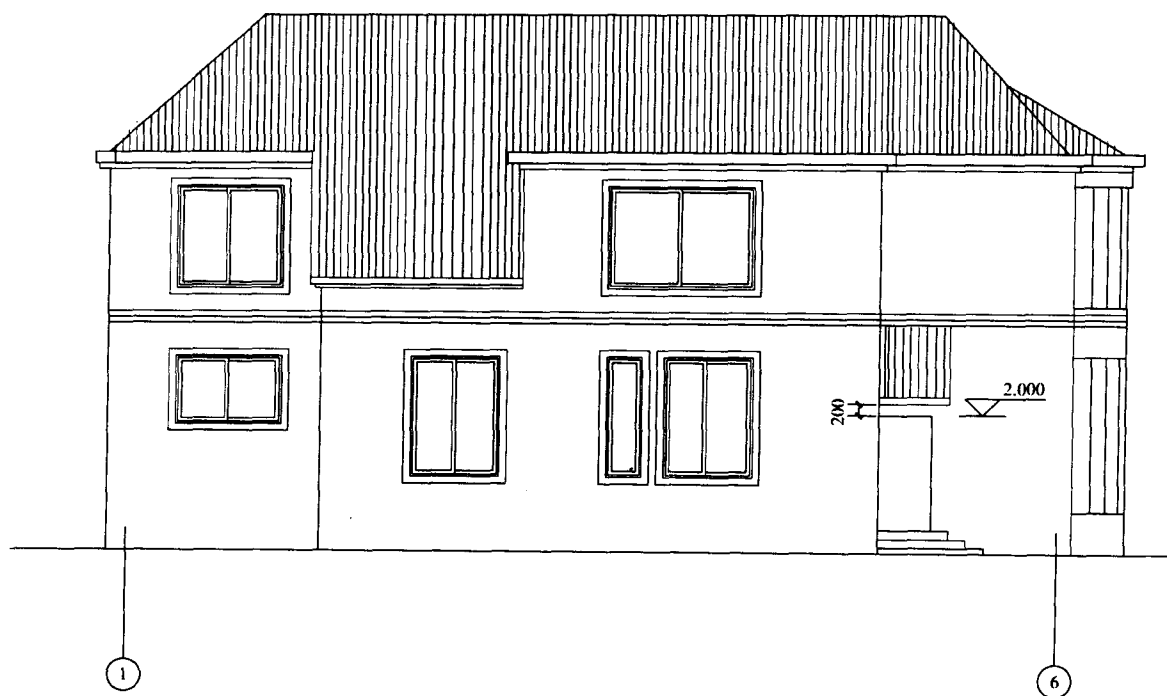
图1-1-5 某二层住宅侧①~⑥轴立面图
