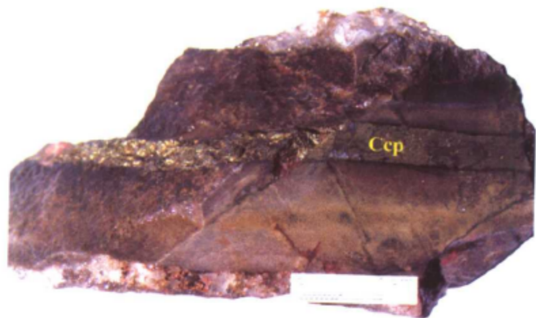
图版5 脉状构造 黄铜矿（Ccp）-石英脉沿围岩裂隙充填成脉状构造 安徽铜官山
