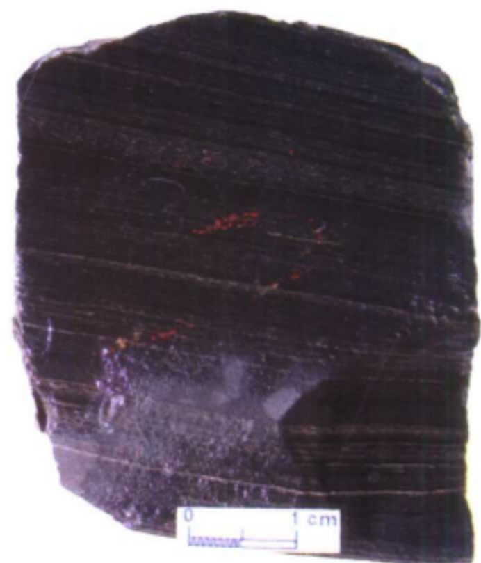
图版 36 层纹状构造 黄铁矿、方铅矿、闪锌矿组成的细层纹 (浅黄色) 于白云岩 (黑色) 中 河北高板河
