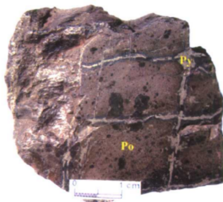
图版6 交错脉状构造 黄铁矿（Py）沿两组解理穿切磁黄铁矿（Po） 吉林天宝山
