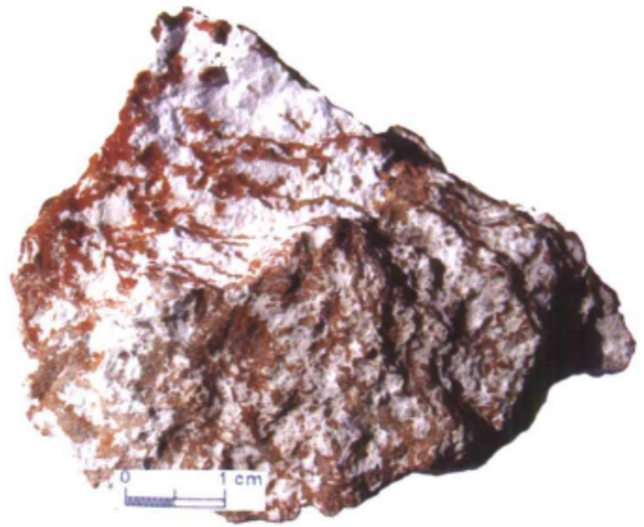
图版 32 皮壳状构造 水锌矿 (白色) 覆盖在褐铁矿 (土红色) 表面呈皮壳状 广西泗顶厂
