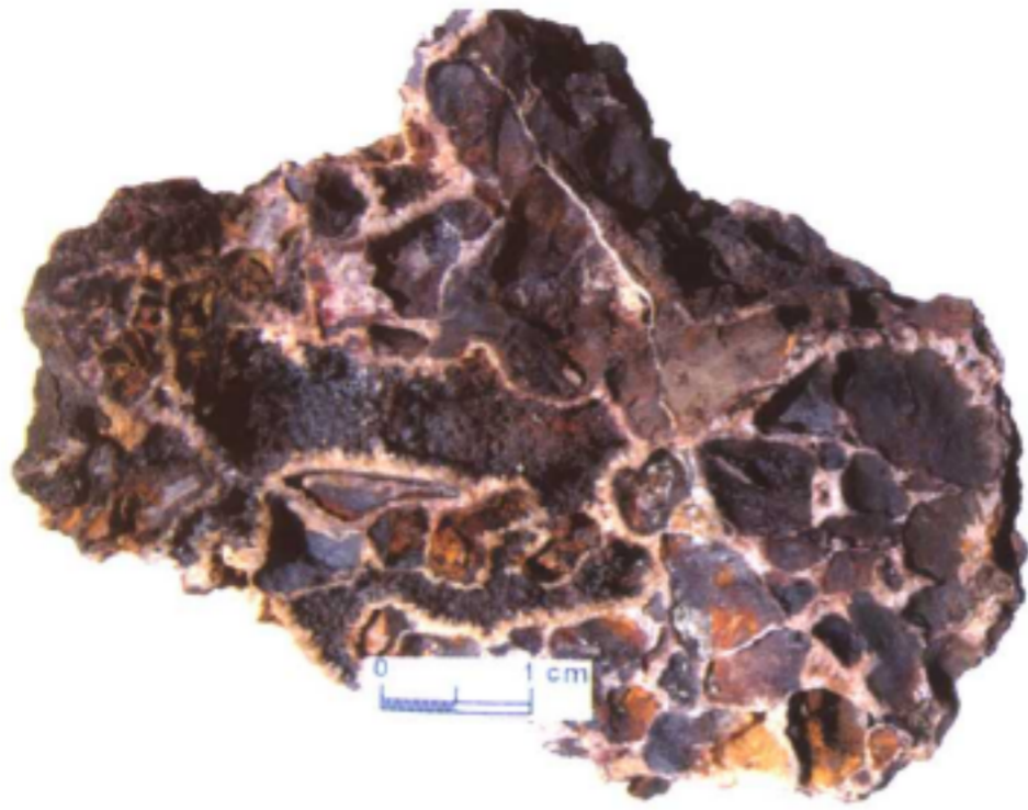
图版 25 蜂窝状构造 由褐铁矿（红褐色—黄褐色）和硅质（白色，组成格架） 构成的蜂窝状构造
