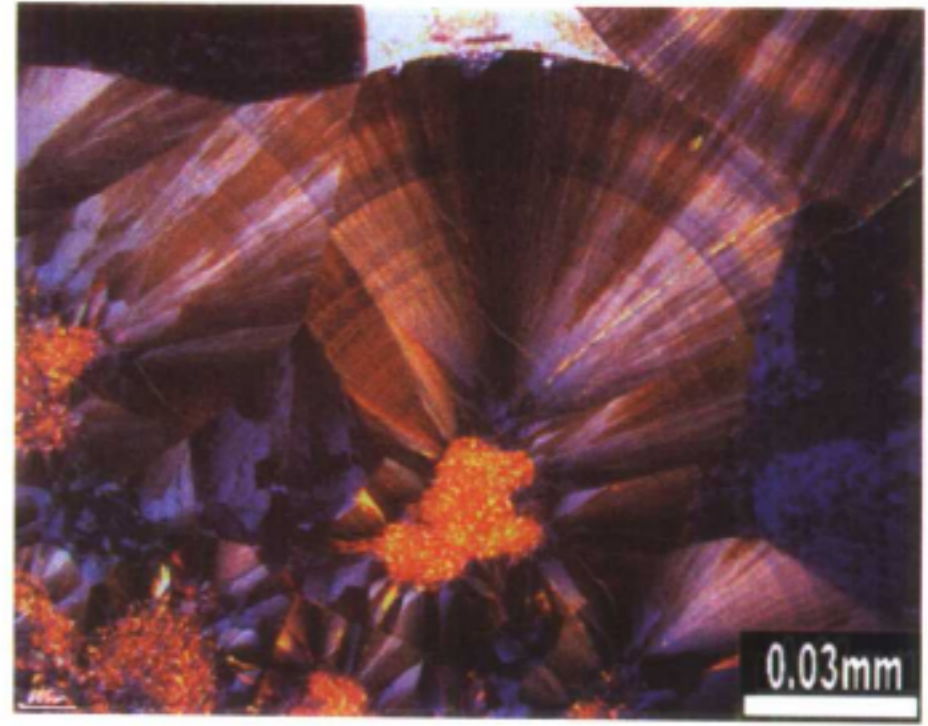
图版 26 变胶状构造 针铁矿呈放射状集合体，仍残留有胶体同心圆状构造 光片 10 \times 50 (+)
