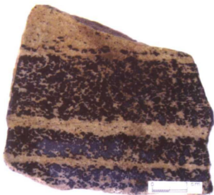
图版3 条带状构造 铬铁矿（黑色）在蛇纹石化橄榄岩中呈条带状分布 陕西高南
