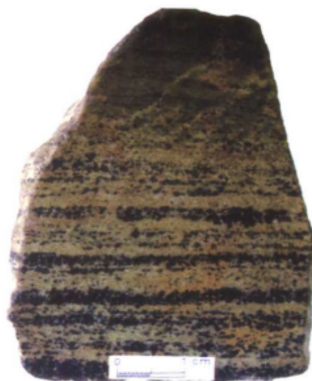
图版4 浸染-条带状构造 铬铁矿（黑色）呈浸染-条带状分布于蛇纹石化橄榄岩中 陕西高南
