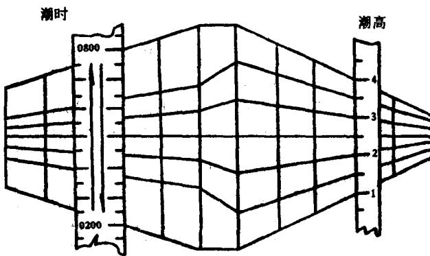
如图所示。使潮时尺上涨潮一边的读数0200和0800处分别与图卡左侧的上下两斜边相接；使潮高尺上1.0m和4.0m处分别与图卡右侧上下两斜边相接（潮时尺和潮高尺应与图卡上的垂直线平行）。然后通过图卡中的放射状斜线查得
