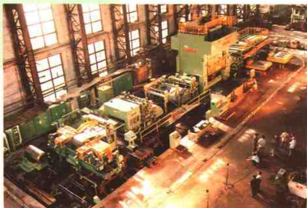
1830 開卷落料堆垛生產綫成套設備(與日本國株式會社 小松製作所合作製造)
