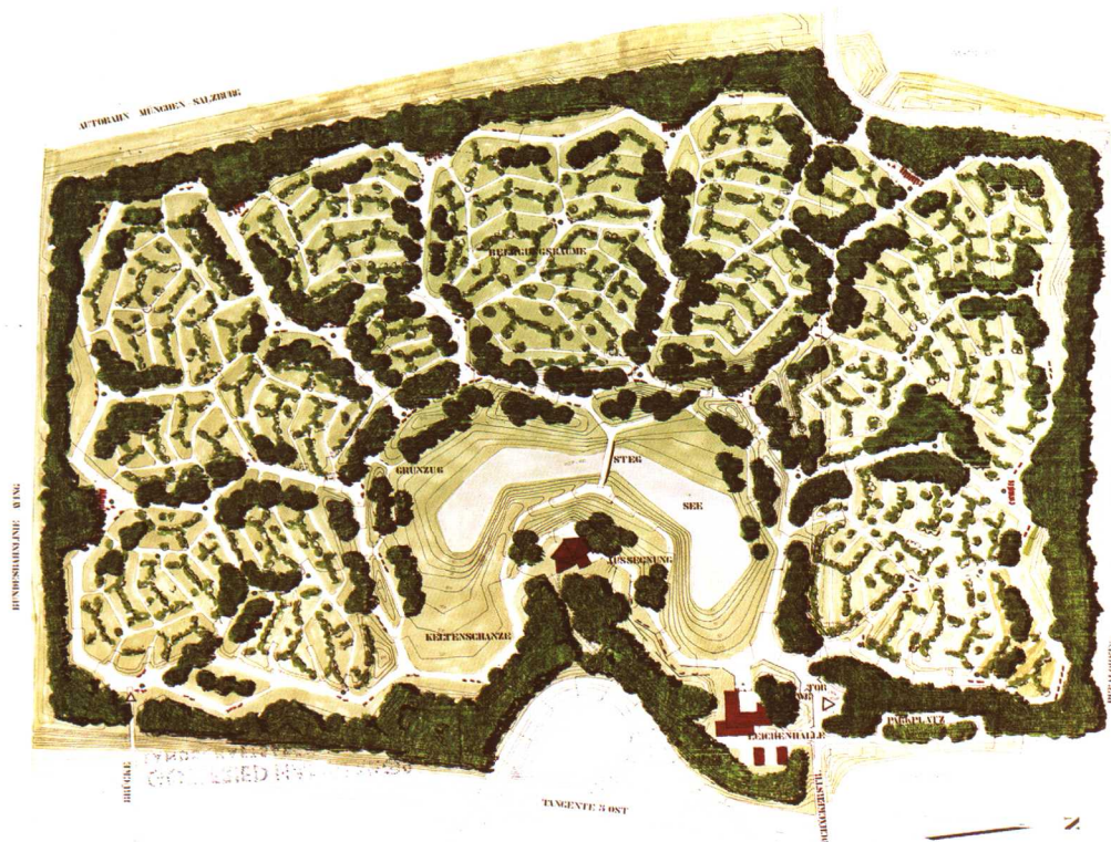
土做的堤岸用来阻隔高速公路和周边道路对场地的影响。
