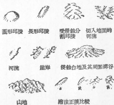
圖 3. 透視圖解上各種基本地形形式的繪法
