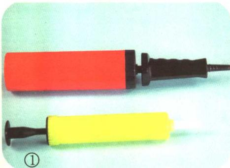
图①上为双向打气筒，推下去和拉回来都会充气；下为单向打气筒，只有先拉出，推下时才能充气。
