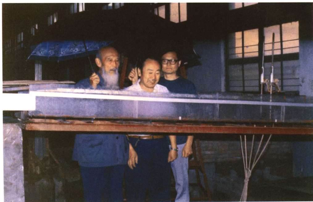
人工降雨下的坡面流试验
