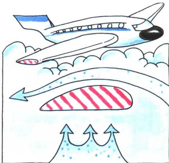
飞机翅膀上方的气压低于下方的气压，所以飞机就飞起来了。
