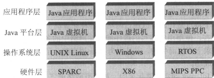
图 1-2 Java 虚拟机针对不同软硬件平台的实现
