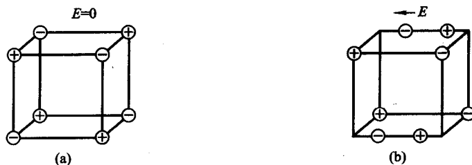
图 1-2 离子式极化示意图
