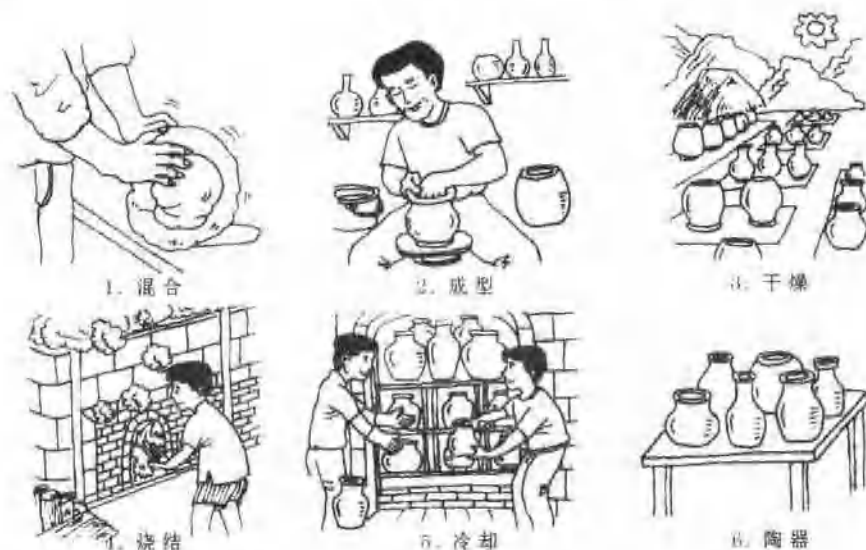
图 7-11 陶瓷器制造过程示意图
