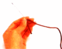
② 洞口太小时用的穿线器。 (洞口 1cm 时用)
