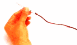
③ 洞口大时用的穿线器。 (洞口 2cm 时用)
