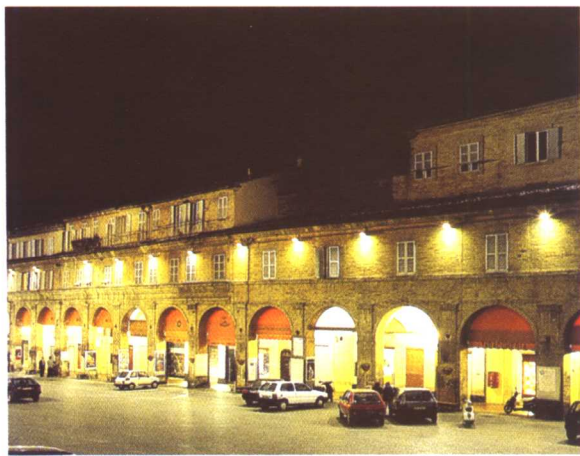
图31 安装在建筑墙面上的泛光灯通过其在墙面上投射出的有规律的光斑来塑造建筑夜景，同时也为楼前广场提供照明，满足车辆和行人的通行需要
