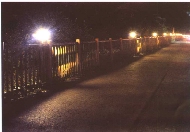
图 44 这一灯具不仅为人行步道提供照明,其更大的作用在于通过将围栏外侧和树木绿带照亮,给了行人安全感
