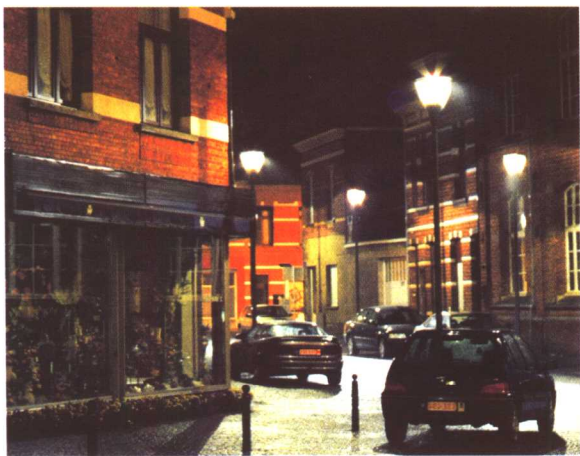
图29 古老的建筑，曲折的街巷，凝聚了城市的历史和文化。无论搞什么样的市政建设，都应对它们给予足够的尊重，对待城市中特色环境的态度，在很大程度上体现了一个民族的素质。本例根据环境特点，有针对性地选择灯具的功能和形式，使照明效果兼顾地面照度和空间的垂直照度，同时让建筑也得到适度的展示，既满足车辆和行人的通行需要，也让道路照明起到了装点环境的作用，在功能性和装饰性之间达成了平衡，并且，明亮的空间环境也有助于消除狭窄小巷可能带来的不安全感
