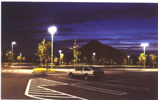
图 65 停车场照明应充分展示场地出入口、地面的车位标线和行车走向标线以及乘车人下车后的步行通道
