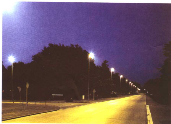
图 55 树木种植线后退能有效避免遮光问题
