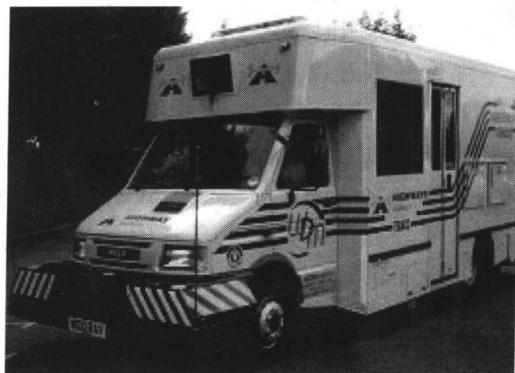
图 1-21 路面裂缝检测车
