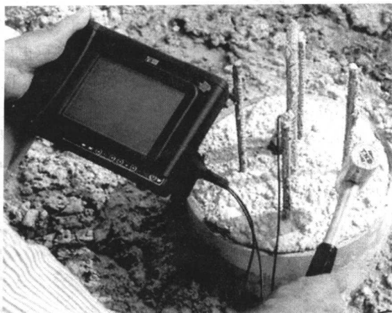
图 1-8 桩基完整性低应变反射波动力检测
