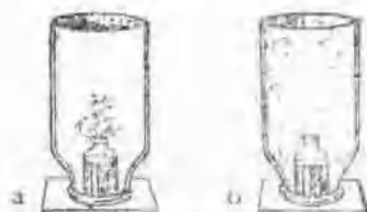
图3. 溴蒸气的扩散: a. 盛溴的小瓶剛用广口瓶罩住; b. 广口瓶里的空气染上了溴的蒸气的顏色
