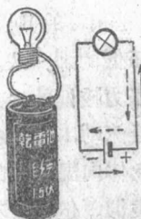
圖 I. 1 最簡單的電路 及其符號
