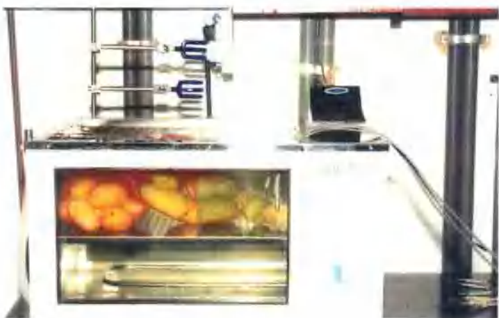
芒果小型热水处理试验
