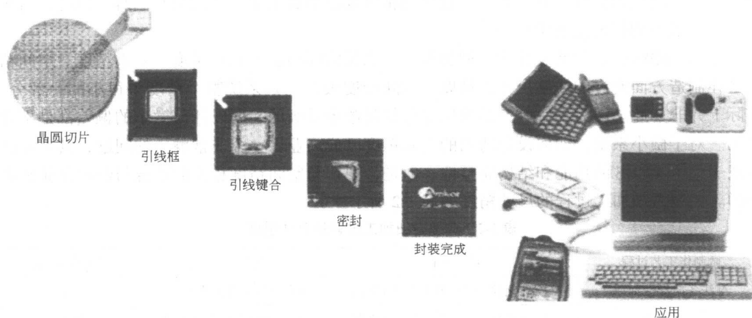
图 1-6 MEMS 封装的主要过程
