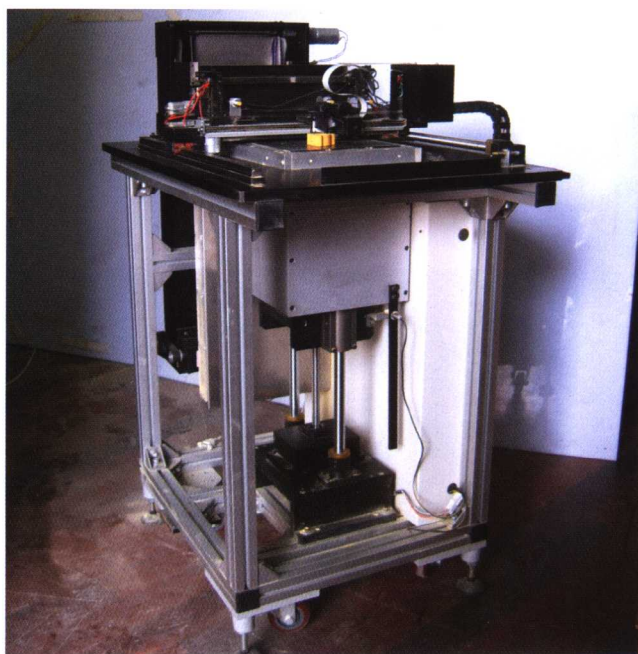
彩图 15 LTY 系列快速成形机采用漏斗—辊轮式的铺粉与刮平机构
