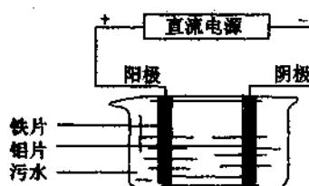
接通直流电源后,与直流电源正极相连的阳极铁失去电子生成  $\text{Fe}^{2+}$ ,进一步被氧化,并生成  $\text{Fe(OH)}_3$  沉淀,  $\text{Fe(OH)}_3$  有吸附性,可吸附污物而沉积。
