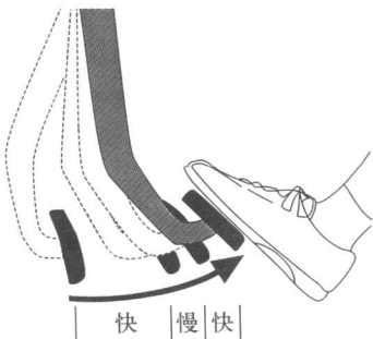
图2-7 离合器“两快一慢”的操作方法
