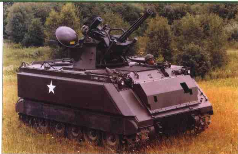
▲ 服役后期，M163 式“火神”防空系统 (PIVADS) 通过改进，能力得到提高，并且随着火控系统的改进，其有效射程提高到 2600 米。
