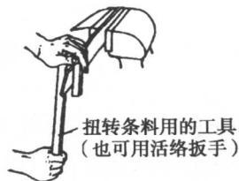
图 1-4 扭转法矫正变形
