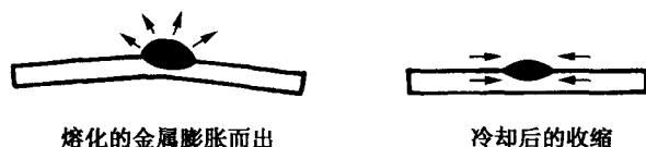
图 1-7 火焰矫正的原理
