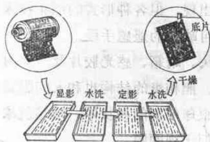
图10 底片的冲洗过程
