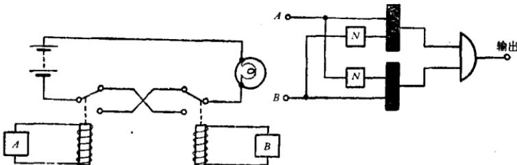
如果“ $A$ 接通  $B$ 断开”，或“ $A$ 断开  $B$ 接通”，则灯泡都亮。用逻辑式可以写成：输出 =  $(A \text{ 与 } \bar{B})$  或  $(\bar{A} \text{ 与 } B)$ 。所示的这个逻辑图则是：输出 =  $(A \text{ 或 } \bar{B})$  与  $(\bar{A} \text{ 或 } B)$ 。请比较上述的两个等式。
