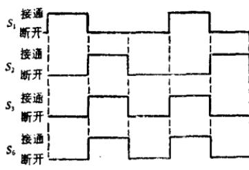
研究一下波形可以看到，这里只有在两个输入端同时都接通的情况下，S<sub>6</sub>是接通的。然而，“或”门只要有一个（或多个）输入端接通，输出端就接通。
