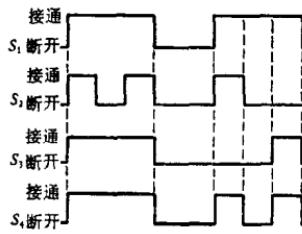
研究一下波形，你就会看到，在两个或两个以上的输入端接通时，S<sub>6</sub>就接通了。而“与”门必须在所有输入端都接通时，输入端才能接通。只要一输入端断开，输出端就断开。
