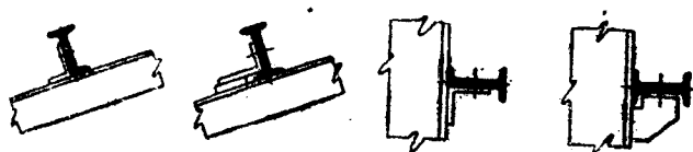
圖 6 工字鋼截面屋面標條與牆架擋風橫梁固接圖
