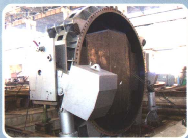
应用于丰满水电站的 DN5300mm 全国最大口径水轮机进水蝶阀
