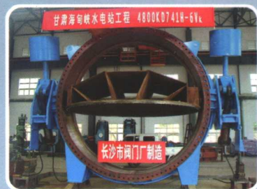
应用于甘肃海甸峡水电站的 DN4800mm 特大口径液控金属硬密封蝶阀
