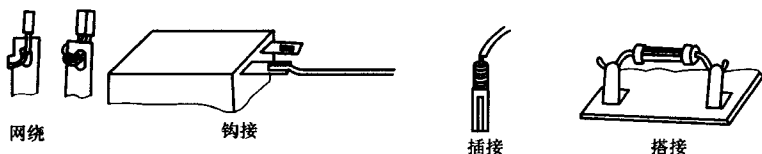
图 1-7 一般结构焊接前的连接方式
