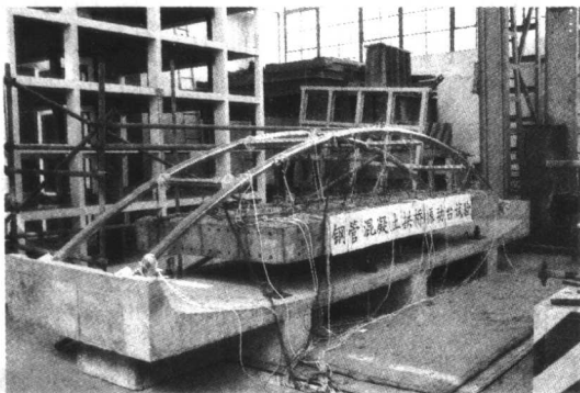
图 1-4 钢管混凝土拱桥振动台试验
