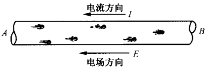
图 1-6 在电场力的作用下，自由电子的有规则的定向运动形成了电流
