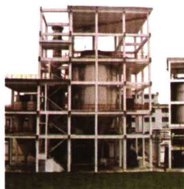
LPG 型高速离心喷雾干燥机
