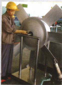
对大风扇进行静平衡试验
