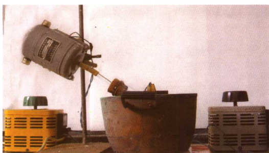
图 13 化学沉积法制备金属膜电阻器
