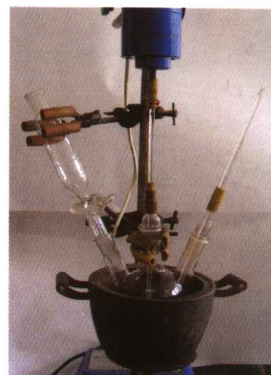
图 18 氯化亚铜制备及催化苯环膦酸化实验装置
