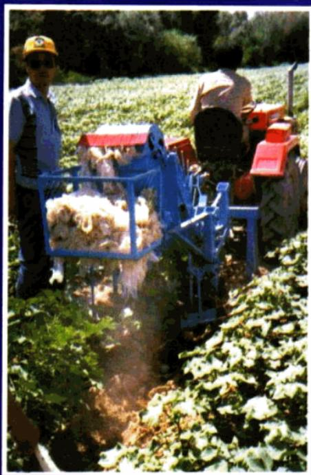
农八师 134 团生产的浇头水前收膜机，收膜率 75%，图为用小四轮拖拉机配套的单幅残膜回收机在作业。
