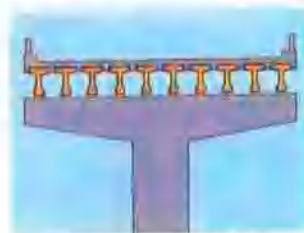
●預力樑：公路橋 • 鐵路橋
