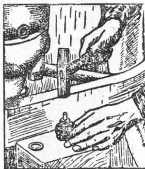
图8 打入可熔塞(安全塞)
