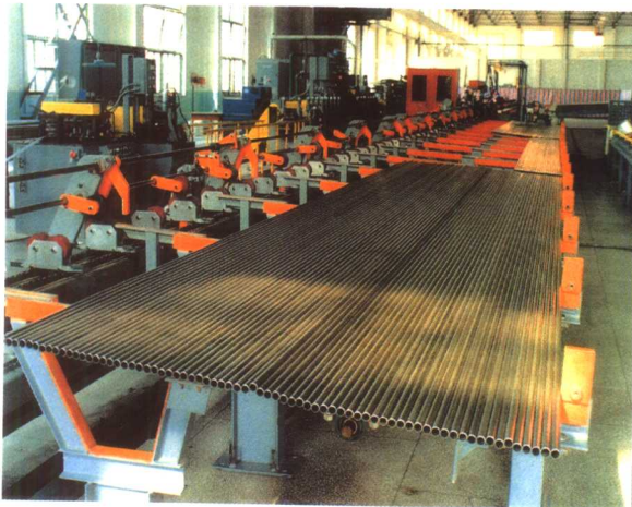
钛焊管生产线
