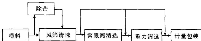
加工常规水稻种子时，为了保证种子的流动性，需要将水稻种子的芒除去；风筛清选可以将种子中的轻杂质、大杂质和小杂质去除掉；窝眼筒清选可以将比种子长的或短的杂质去除掉；重力清选可以将种子中的重杂质及发芽和霉变的籽粒清除掉。
