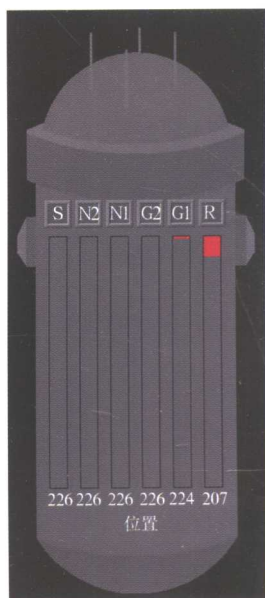
图 4-10 100% 额定功率时控制棒位置
