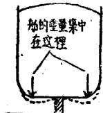
图19 船舶在坞墩上的受力情况及变形
