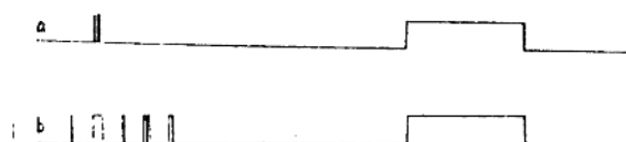
图6 杂波抑制电路对开关脉冲的影响
